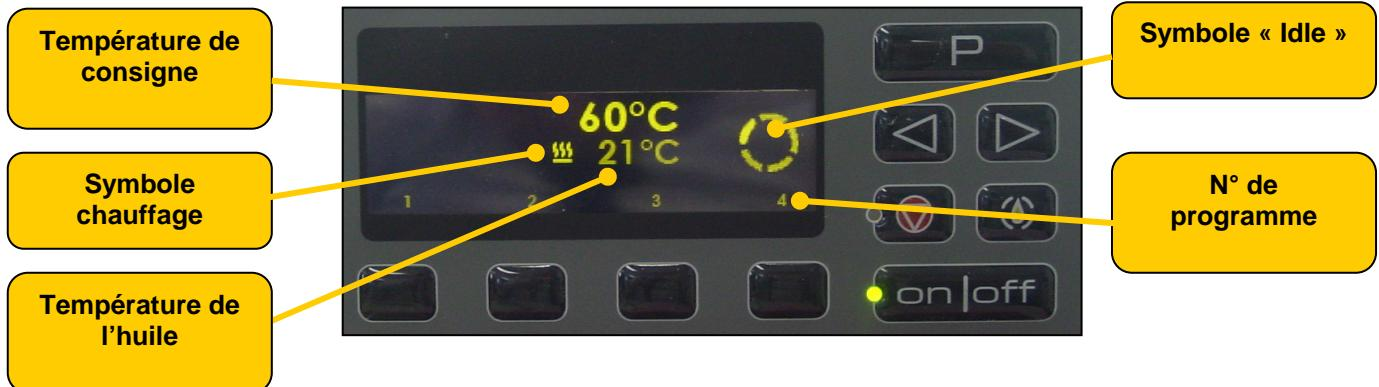
La position fonte de graisse permet d'atteindre une température de consigne en alternant les phases de chauffage et de repos. Ainsi si la graisse figée est utilisée, celle-ci prendra sa forme liquide sans dégagement de fumée ou dégradation.
