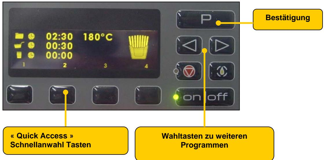
Die „Quick Access“ Tasten ermöglichen ein direktes anwählen eines Frittierprogrammes.
