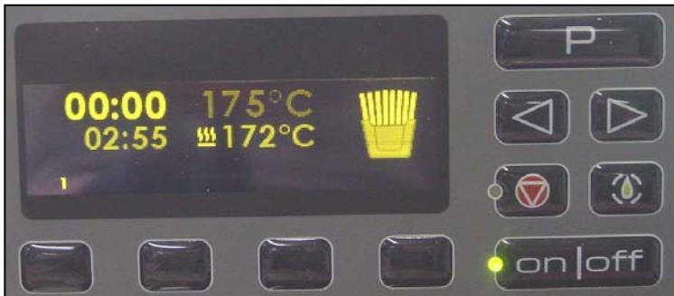
Die Zeitanzeige blinkt „0.00“ und das akustische Signal informiert den Bediener über das Ende des Frittierzyklus. Die Zeitdauer des Signals wird im Programmier Modus eingestellt.
