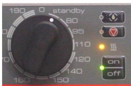
Die „Standby“ Position ist gleichzeitig der Fettschmelzyklus. Dieser ermöglicht Fett / Oel schonend auf 60°C aufzuheizen. Die Heizung wechselt zwischen einer Heiz- und Ruhephase. Somit wird Fett schonend verflüssigt und Fett / Oel ohne Rauchentwicklung aufgewärmt und deren Lebensdauer erhöht.
