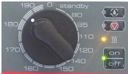
La sélection de la température de cuisson est réalisée en positionnant le curseur sur la consigne souhaitée.
