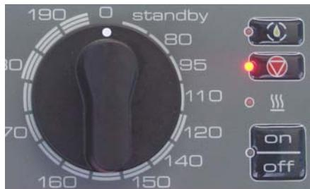
Nach dem anschliessen an das Stromnetz muss der Sicherheitsthermostat initialisiert werden.
