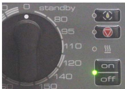
Mit der EIN Taste wird das Bedienpanel unter Spannung gesetzt.
