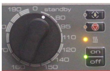
La sélection du mode « Standby » permet d'atteindre la température de 60°C en alternant les phases de chauffage et repos. Ainsi dans le cas d'utilisation de la graisse celle-ci prendra son état liquide sans dégagement de fumée ou dégradation.
